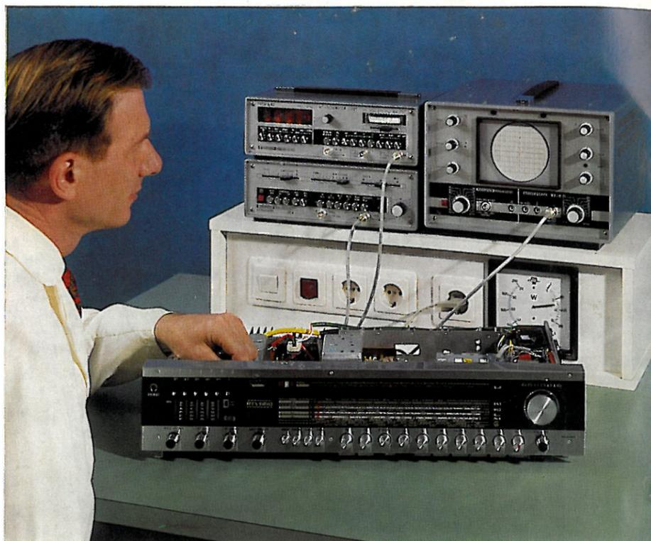
Stereo-Steuergerät-Abgleich mit GRUNDIG Stereo-Coder SC 5
