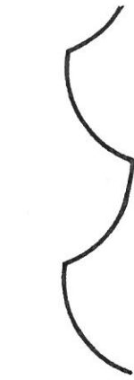
Bild 7: Ausgangsspannung bei Schwingneigung des Verstärkers
